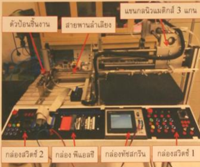
โครงสร้างของต้นแบบชุดฝึกการเขียนโปรแกรมพีแอลซีควบคุมแขนกลนิวแมติกส์ 3 แกน
