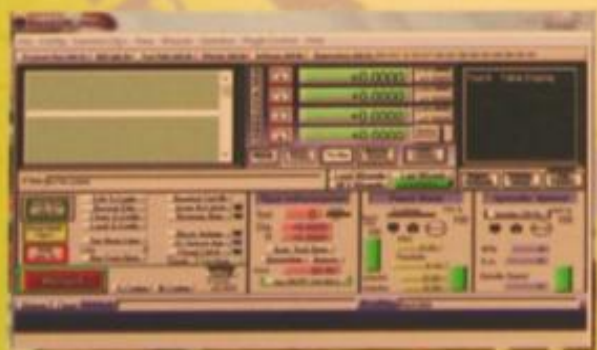
หน้าจอโปรแกรมการ Mach3 ที่ใช้ในการควบคุมเครื่องกัด
