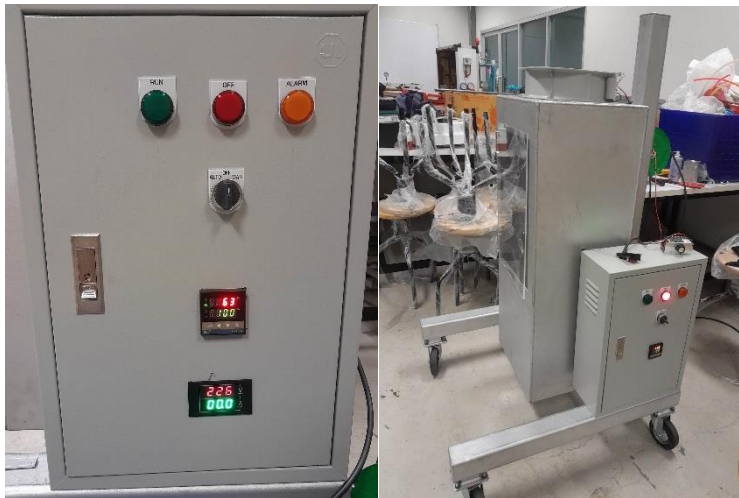
ภาพที่ 3-15 ตู้ควบคุมไฟฟ้าสำหรับฮีตเตอร์
