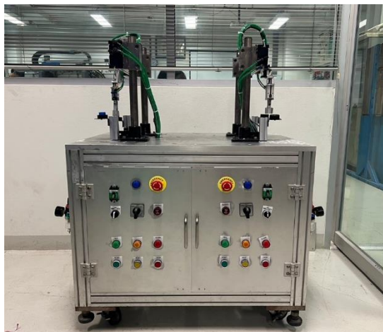
ภาพที่ 4-1 ชุดฝึกแขนกลอัตโนมัติระบบนิวแมติกส์ ควบคุมด้วย PLC
