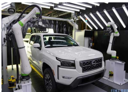
ภาพที่ 2-5 การประกอบชิ้นส่วนรถยนต์โดยใช้แขนกล (ที่มา www.mreport.co.th )
