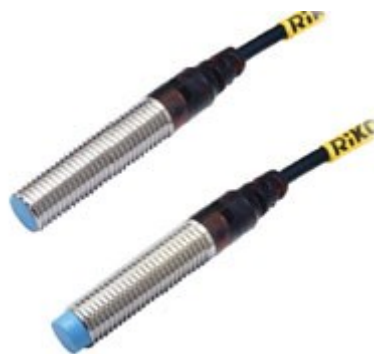
ภาพที่ 2-7 Proximity sensor แบบเกลียว
