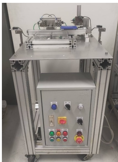
ภาพที่ 4-1 ชุดฝึกเครื่องตัดแยกวัสดุ ควบคุมด้วย PLC
