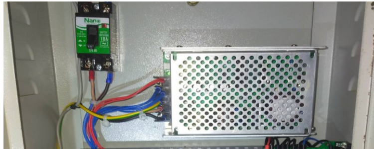
ภาพที่ 3-5 แสดงการติดตั้ง Power Supplyและเบรกเกอร์
