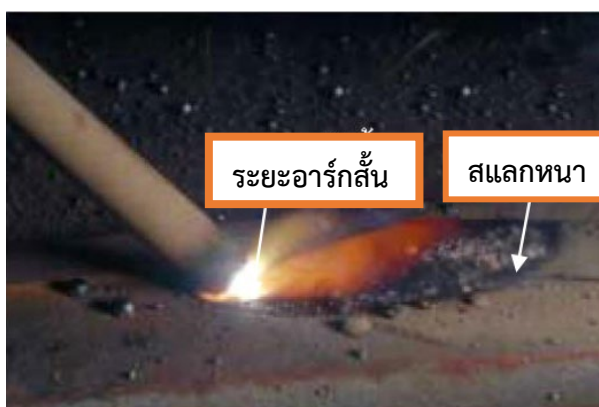
ภาพที่ 2-2 การเชื่อมมีระยะอาร์กสั้นหรือแคบเกินไป
