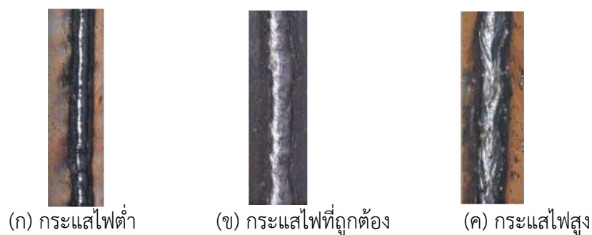
ภาพที่ 2-4 ผลกระทบของกระแสไฟที่มีต่อรูปร่างของแนวเชื่อม
