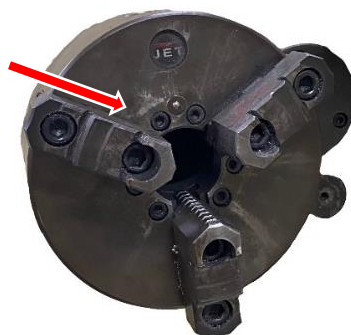
ภาพที่ 2-10 หลักการทำงานของหัวจับแบบ 3 ฟันพร้อม
