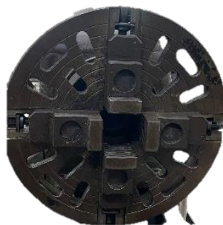
ภาพที่ 2-11 หลักการทำงานของหัวจับแบบ 4 ฟันอิสระ
