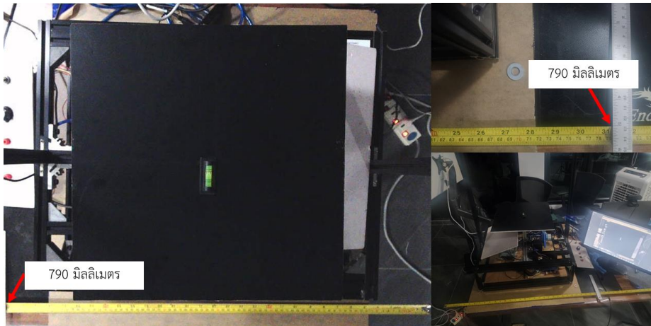
ภาพที่ได้จากกล้องเว็บแคม ภาพการวัดจริง ภาพที่ 4-3 การทดสอบพื้นที่ในการรับภาพของกล้อง
