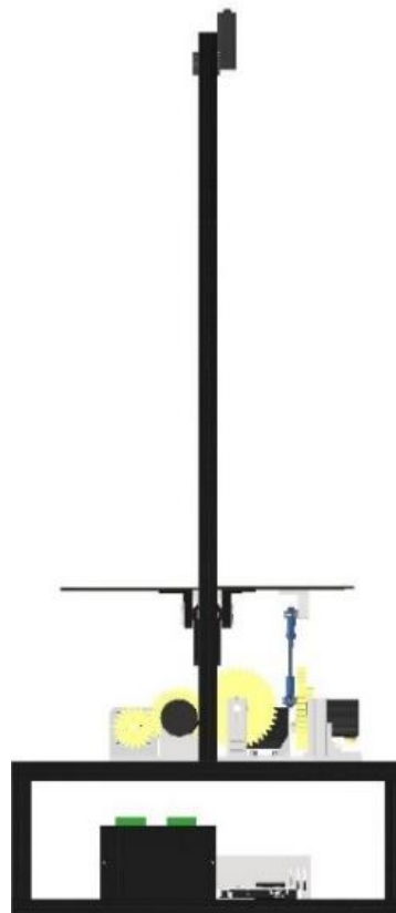
ภาพที่ 3-9 ภาพระบบควบคุมบอลทรงตัวบนแผ่นด้วยโปรแกรมซอลิดเวิร์กส์ ด้านข้าง
